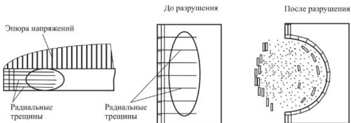
Рис. 4 – Механизм радиально-послойного разрушения угольного вещества при разгрузке в предельно напряженном состоянии
